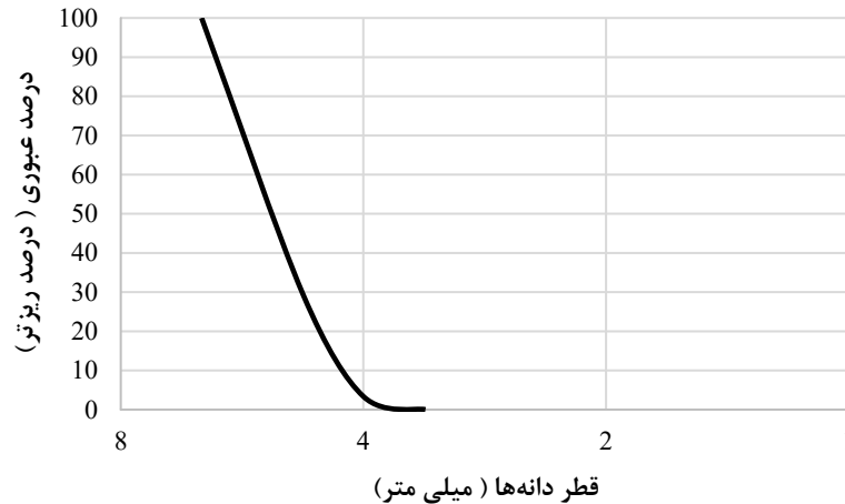
شکل ۴. نمودار دانه‌بندی ذرات سیلیس مورد آزمایش Fig. 4. Particle size distribution curve of the tested silica particles
