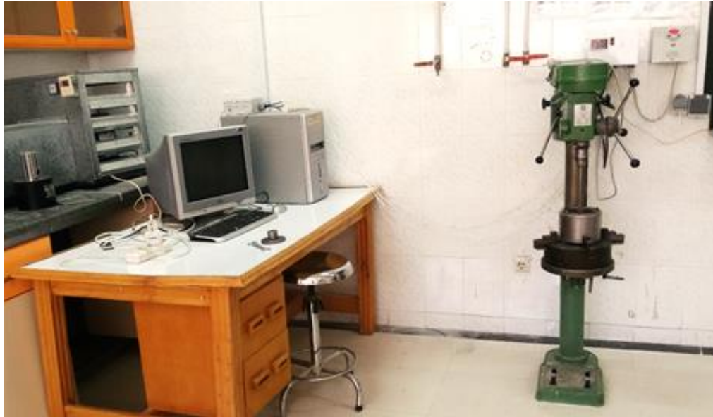
شکل ۱. دستگاه آزمایش LCPC ساخته شده در دانشگاه صنعتی سهند به همراه تجهیزات جانبی Fig. 1. The LCPC testing device and its accessories manufactured at Sahand University of Technology
