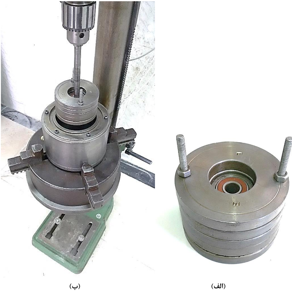
شکل ۲. (الف) وزنه‌های مورد استفاده، (ب) چگونگی نصب وزنه‌ها در دستگاه آزمایش LCPC Fig. 2. a) the used loading weights, b) the installation of loading weights on the testing device
