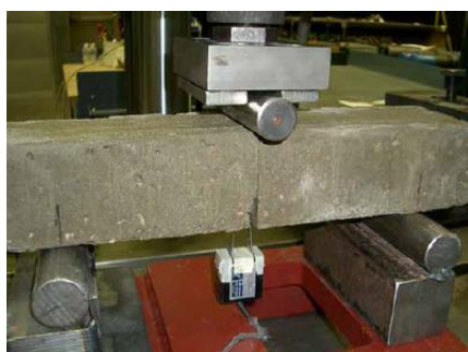
شکل ۴. هندسه تیر در نمونه‌های آزمایش خمش سه نقطه‌ای [۲۵] Fig. 4. The geometry of the beam in the three-point bending test
