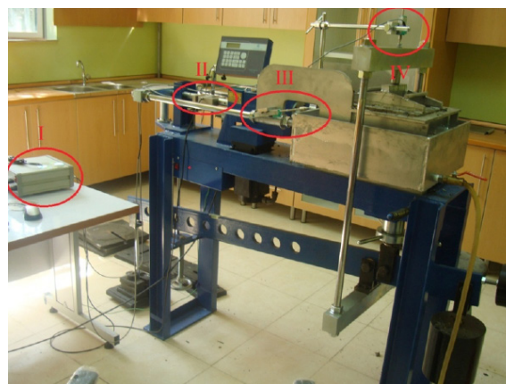
شکل ۳. تصویری از دستگاه برش مستقیم بزرگ مقیاس مورد استفاده و متعلقات آن، (I. دستگاه دیتالاگر جهت ثبت داده‌ها، II. نیروسنج، III. کرنش سنج افقی، IV. کرنش سنج قائم)
