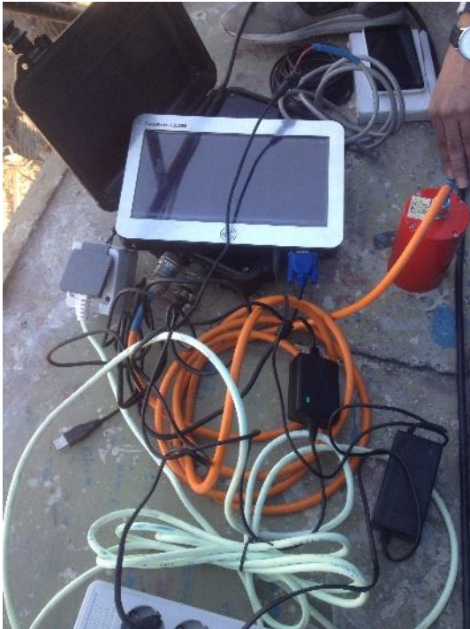
شکل ۴. حسگر سرعت سنج به همراه سایر تجهیزات اندازه‌گیری مستقر در راه دسترسی کنار تانکر
