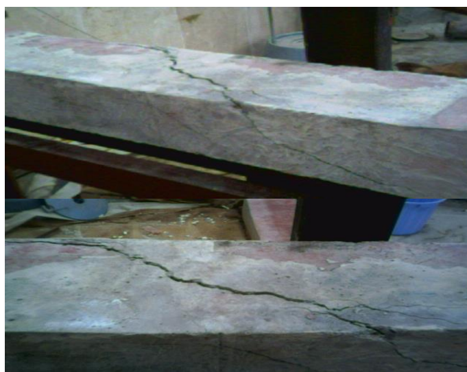
شکل (۶): چگونگی ترک خوردگی در نمونه ۴
