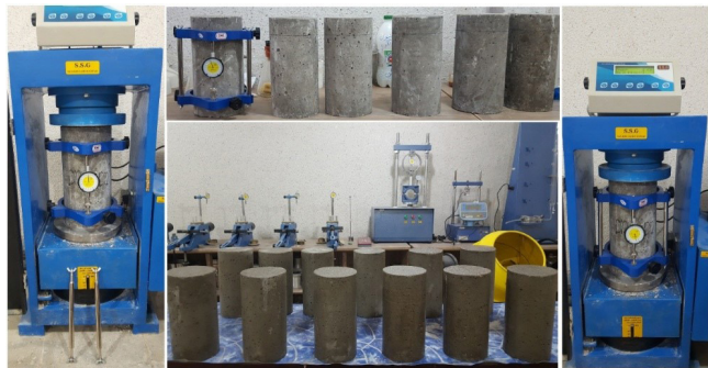
شکل ۸: روند انجام آزمایش تعیین ضریب ارتجاعی
