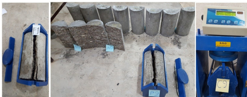
شکل ۶: روند انجام آزمایش تعیین مقاومت کششی به روش دونیم شدن
