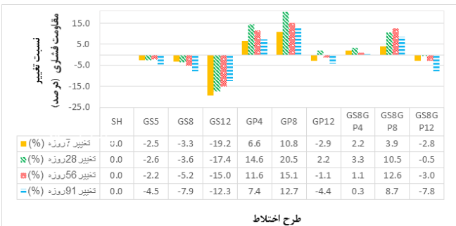
شکل ۱۲: نسبت مقاومت فشاری طرح‌های اختلاط به طرح مرجع
