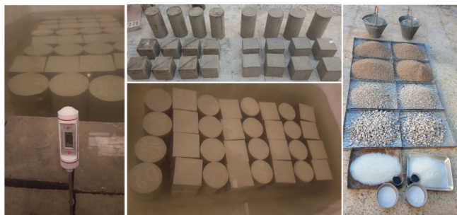
شکل ۵: روند ساخت، نمونه‌گیری و عمل‌آوری نمونه‌ها
