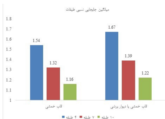
شکل ۱۲: متوسط نسبت جابجایی نسبی طبقات در حالت متوالی به منفرد در قاب‌های خمشی با و بدون دیوار برشی (میانگین نتایج حاصل از رکوردهای Chi Chi 1، Irpina 2 و Hollister)
