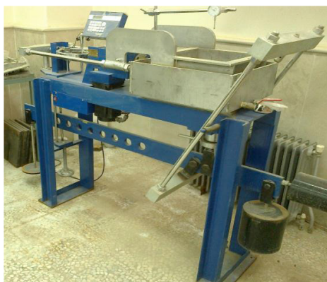
شکل ۳: دستگاه برش مستقیم بزرگ مقیاس استفاده شده در آزمایشات این مقاله
