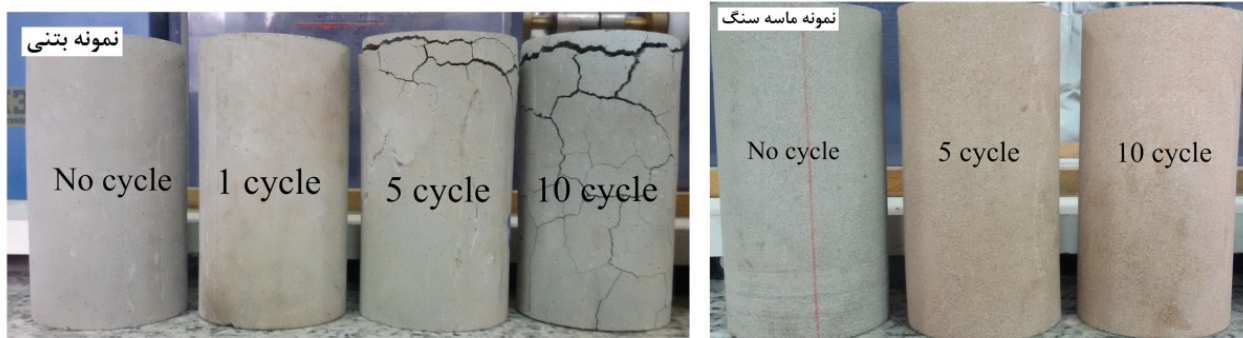
شکل ۱۱: نمونه‌های آماده‌سازی شده جهت اندازه‌گیری سرعت امواج طولی در سیکل‌های گرم شدن (تا ۷۰۰ درجه سانتی‌گراد) - سرد شدن
