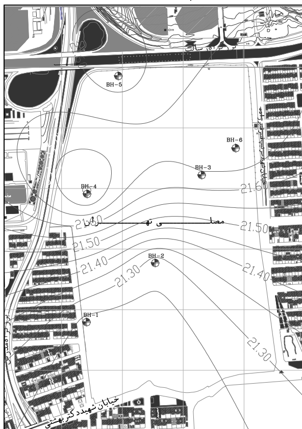
شکل (۱۲): نقشه هم تراز بیشینه سرعت سطح زمین در واحد cm/s - ماکزیمم شتاب سنگ بستر g = 0.35
