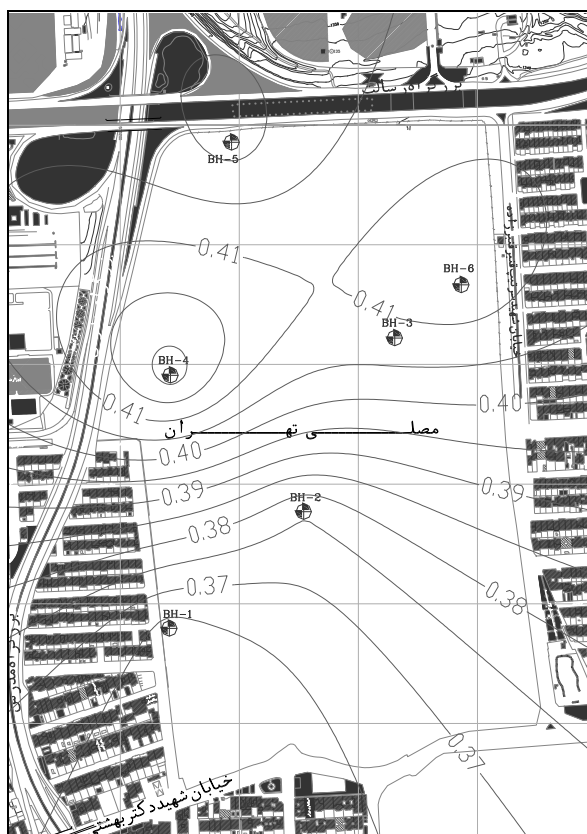
شکل (۱۱): نقشه هم تراز بیشینه شتاب سطح زمین در واحد g = 0.35 - ماکزیمم شتاب سنگ بستر g = 0.35
