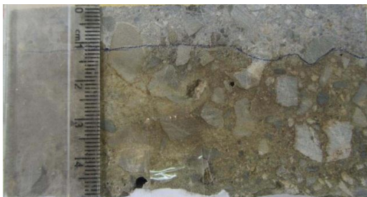
شکل (۱۱) تعیین عمق نفوذ کلرید پس از آزمون RCP بوسیله پاشیدن نیترات نقره ۰/۱ نرمال بر سطح برش زده شده.
