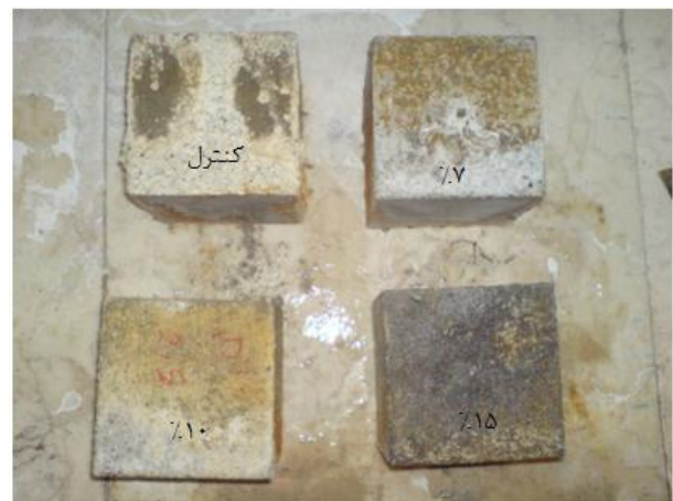
شکل (۴): نمونه‌های بتنی پس از ۴ ماه قرارگیری در سولفات منیزیم ۳-۳- تغییر طول نمونه‌های ملات در محلول‌های سولفات سدیم، منیزیم و سدیم-منیزیم
