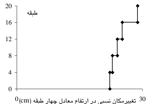
شکل (۱۸): مقادیر تغییرمکان نسبی غیرخطی به دست آمده در طبقات در روش دیوار میان‌خالی
