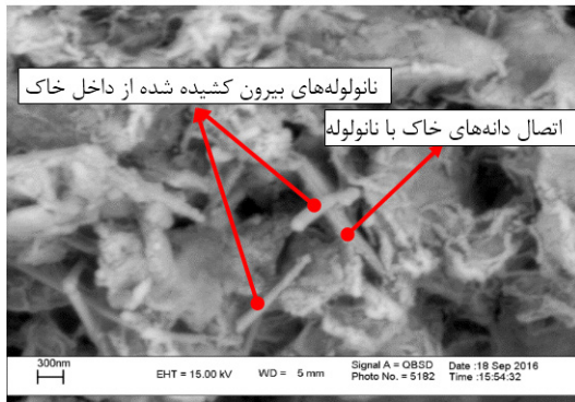
شکل ۱۸: تصویر SEM از خاک ماسه‌ای تثبیت شده با سیمان و نانولوله به مقدار ۰/۱۲۵ درصد وزنی سیمان
